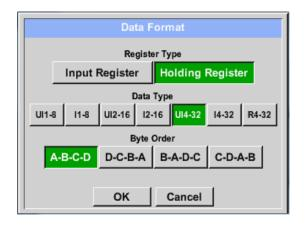
Selection Register Type Holding Register, Data Type *U1(32b)* und Byte Order *A-B-C-D* **HWord LWord** HByte LByte HByte LByte 29235175522 => ΑE 41 56 Data Order 1.Byte 2.Byte 3.byte 4.Byte A-B-C-D ΑE 41 56 D-C-B-A 52 41 ΑE 56 56 B-A-D-C 41 ΑE 52 C-D-A-B 56 52 AΕ 41
