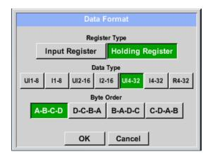
Selection Register Type Holding Register, Data Type *U1(32b)* und Byte Order *A-B-C-D* **HWord** LWord HByte LByte HByte LByte 29235175522 => ΑE 41 56 Data Order 1.Byte 2.Byte 3.byte 4.Byte ΑE A-B-C-D 41 56 52 D-C-B-A 52 56 41 ΑE B-A-D-C 41 ΑE 52 56 C-D-A-B 56 52 ΑE 41
