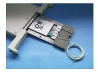
Datapaq DQ1840 datalogger TB7528 thermal barrier Insight™ software
